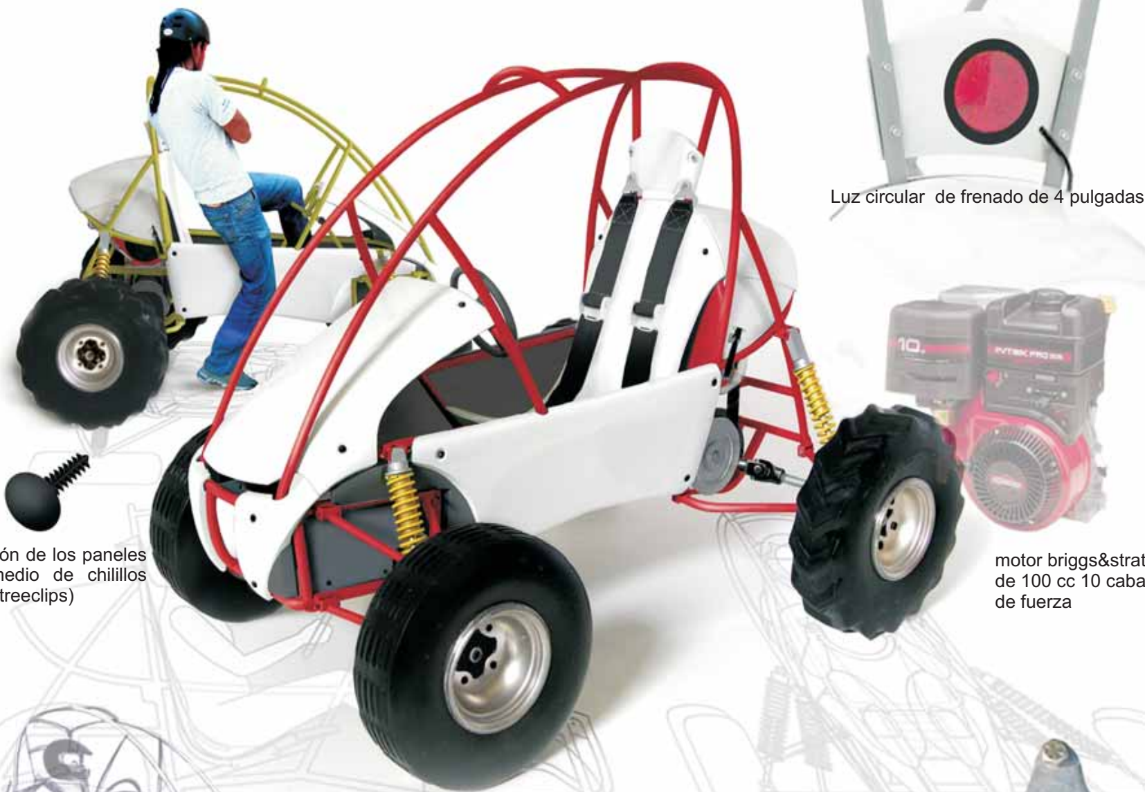
Cinturón de seguridad de 5 puntos afianzado a la estructura
