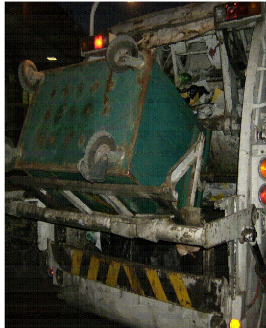
Foto 12. Carga y descarga mecánica de los recolectores.
