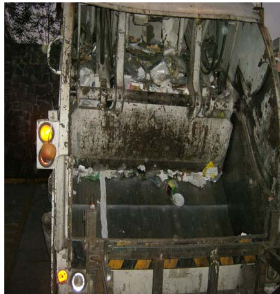
Foto 20. Contenedor con sistema hidráulico-dinámico para la compactación.
