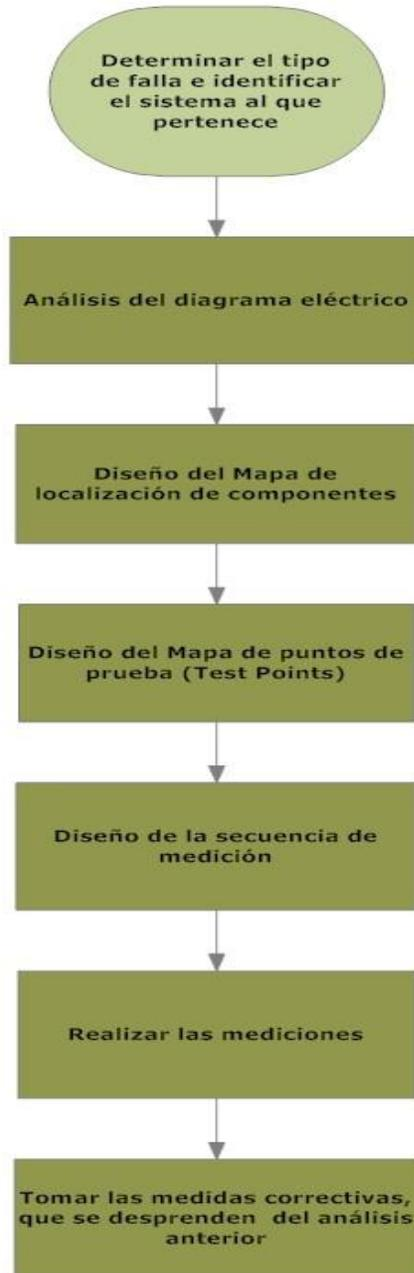
Será muy importante contar con una *GOLDEN UNIT* para obtener las mediciones de referencia que nos servirán como parámetro en futuros análisis y para poder diseñar nuestro Mapa de puntos de prueba.
