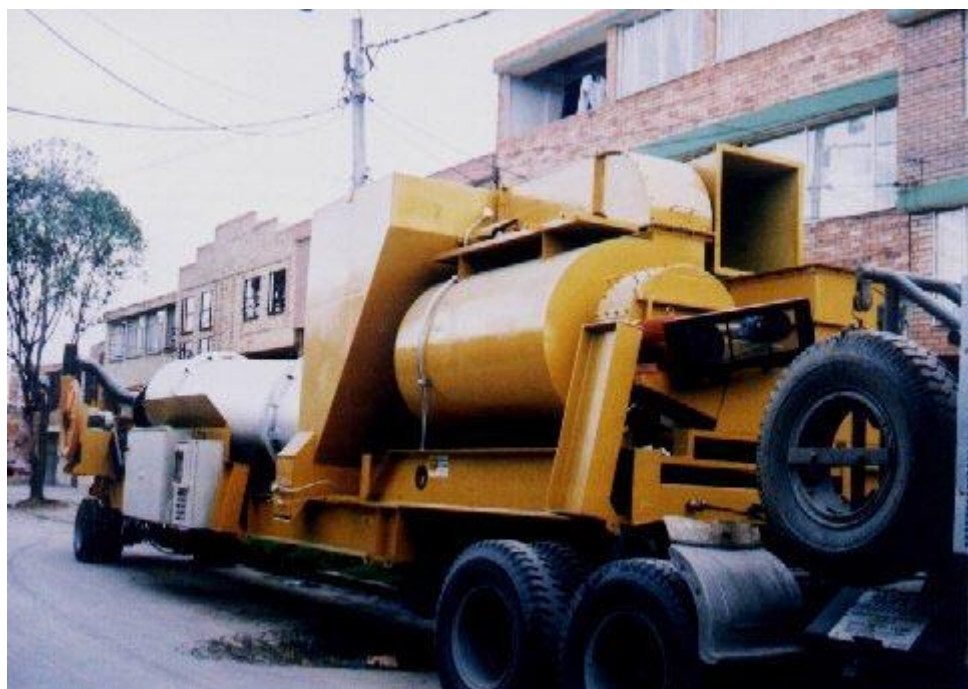
Fig. 12 Equipo de planta de asfalto.
