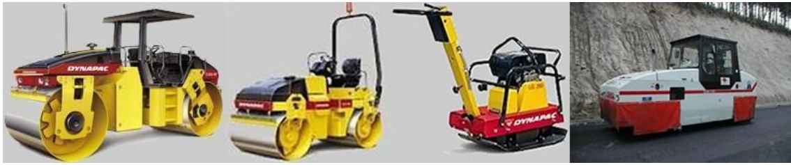
Fig. 28 Diversos equipos de compactación.
