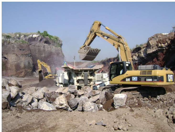
Fig. 87 Excavadora 330 DL llenando la criba.
