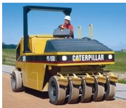
Fig. 30 Compactadora de neumáticos.
