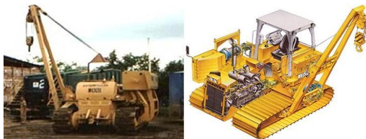
Fig. 24 Grúa tendedora de tubos.
