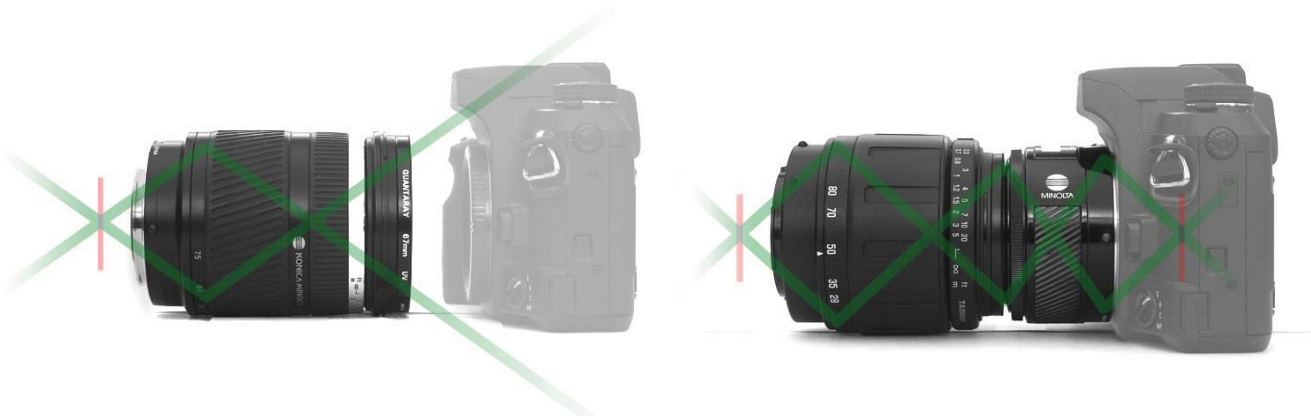
Recorrido general de la luz a través de un objetivo hasta la parte sensible
