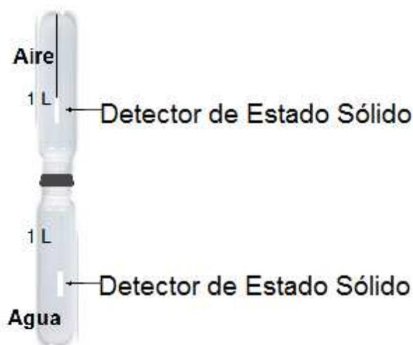
*Figura 8: Dispositivo pasivo de detección de radón en agua.*
