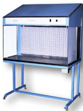
Fig. 1a. Campana de flujo laminar horizontal (1) y vertical (2). Las campanas de flujo laminar horizontales y verticales nos permiten obtener una zona estéril, para preparación de medios de cultivo, siembras no patógenas, preparación de soluciones hipertónicas, entre otras.
