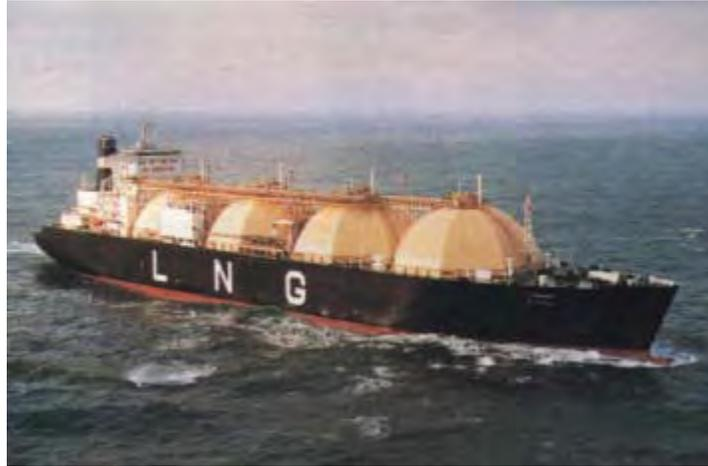
Figura 1.7 Buque metanero de diseño de membrana
