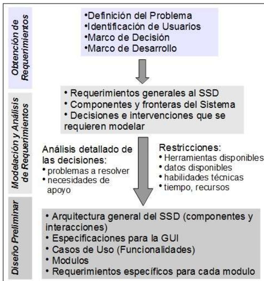
Figura 3-1: Pasos de trabajo – Análisis de Requerimientos Diseño Preliminar (elaboración propia, basado en Sage, 1991 y Saxena, 1991)
