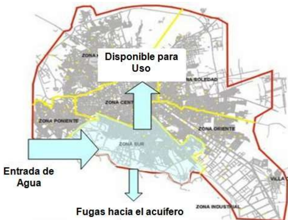
Figura 7-8: Esquema del balance de agua en un sector de la red de agua potable
