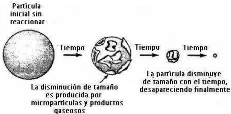
Figura 3-2: Comportamiento de la partícula de  $FeCl_2 \cdot 4H_2O$  a diferentes tiempos de reacción.
