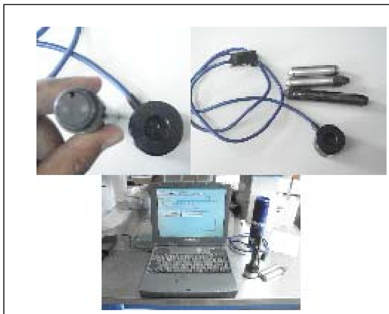
Figura 16. Dispositivos de operación del sensor (Schulumberger, 2006), a) Sensor sin tapa se observan los sensores ópticos al interior del sensor, b) Lector óptico y sensores, c) Equipo completo (PC Portátil, Lector óptico y sensores).
