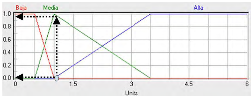
, Figura 5.6: Funciones de membresía de “Variación”, ubicación del valor 1.071 de variación. Membresía a los conjuntos difusos variación baja y variación media y sus correspondientes valores de membresía.
