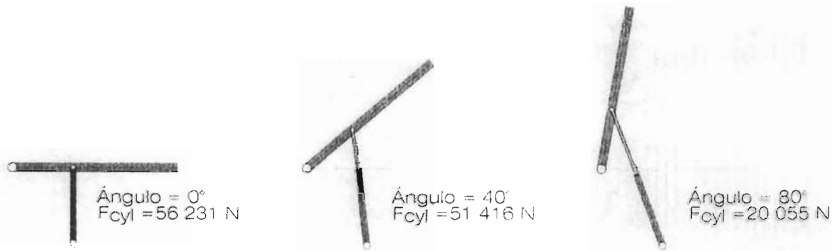
Figura 3. Fuerza en tres posiciones de la cubierta
