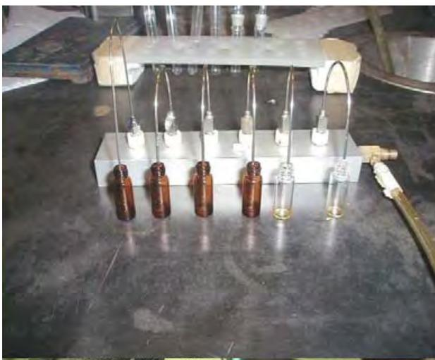
**Figura 15.** Sequedad con nitrógeno grado cromatográfico.
