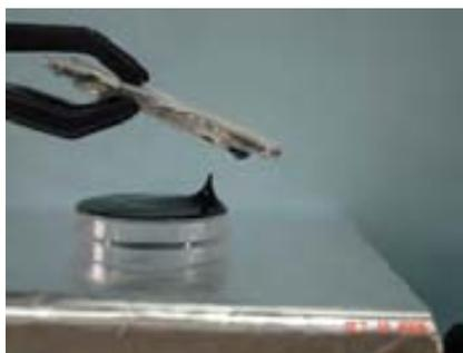
Figura 35. Ferrofluido de magnetita sintetizado, sometido a la acción de un campo magnético externo.
