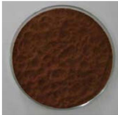
Figura 40. Microesferas poliméricas magnéticas obtenidas encapsulando magnetita mediante polimerización en suspensión de acetato de vinilo con divinil benceno.
