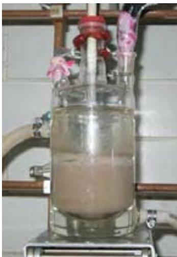
Figura 32. Obtención de microesferas poliméricas magnéticas mediante polimerización en suspensión.
