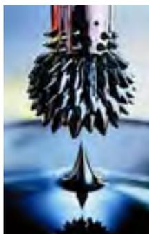
Figura 1. Fotografía de un ferrofluido sometido a un campo magnético.
