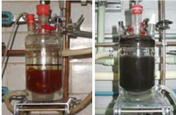
Figura 30. Sales de Fe cargadas al reactor (izquierda). Formación de magnetita (derecha).
