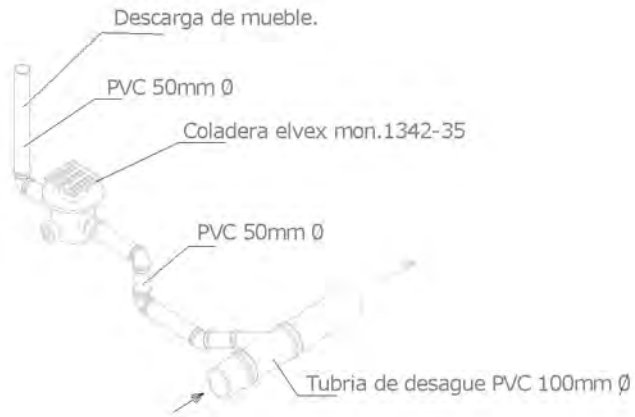
Instalación de coladera en instalacion sanitaria.
