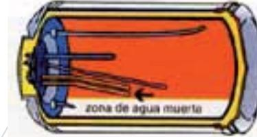
La resistencia inclinada llega hasta 1/3 de la cuba. Se produce una capa permanente de agua fría lo que reduce el agua caliente acumulada.
