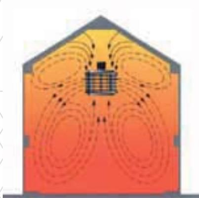
Reducirá su factura de combustible entre un 20% y un 40% Instalando un ELITURBO el aire caliente se distribuye uniformemente, reduciendo la dispersión de calor y el consumo de combustible hasta en un 30 o 40%, dependiendo de la altura del local.
