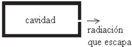
Si se abre un pequeño agujero en el recipiente, parte de la radiación se escapa y se puede analizar. El agujero se ve muy brillante cuando el cuerpo está a alta temperatura, y se ve completamente negro a bajas temperaturas.
