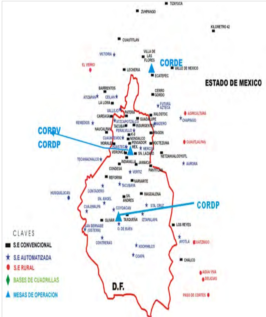
Figura 1.12 Subestaciones pertenecientes al área metropolitana. Fuente: Gerencia de Operación de Redes de Distribución (G.O.R.D) Pedregal, 2006.
