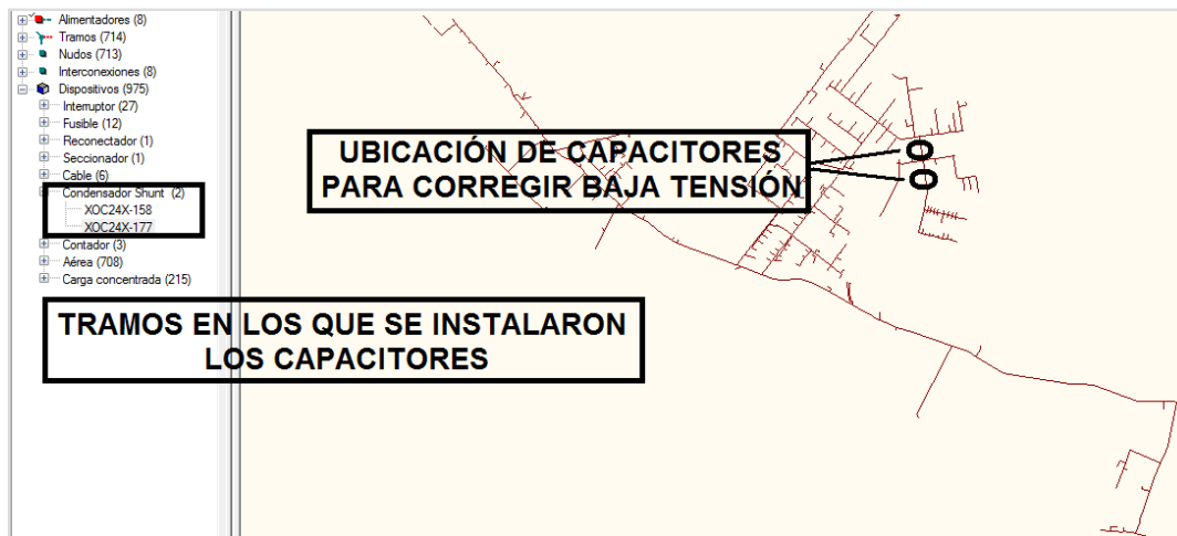
Figura 5.6. Ubicación de capacitores en el alimentador XOC-24X.
