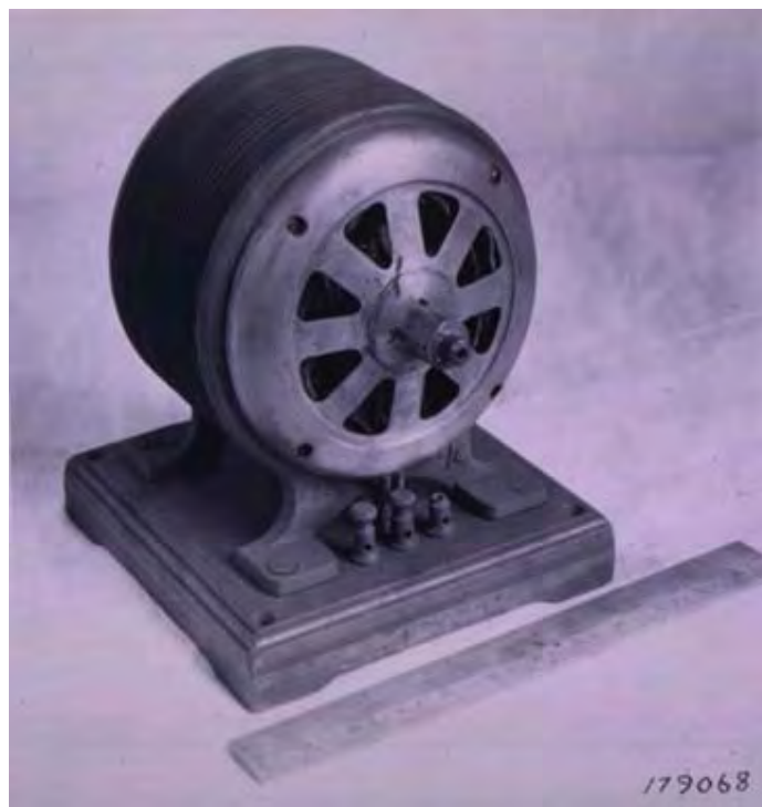
Figura 1.4. Motor de inducción de Tesla, fabricado por Westinghouse.
