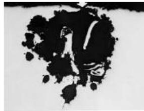
Figura 1.2. Corrosión localizada en una placa de acero
