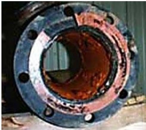
Figura 1.10. Corrosión microbiológica por la presencia y actividad de microorganismos en una brida.
