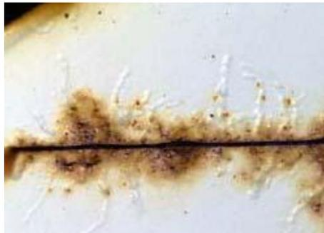
Figura 1.9. Corrosión por filiforme en la línea tangencial de una trampa de condensados.
