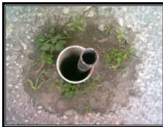
Fig. 7.13 Fotografía del Banco de Nivel Profundo (vista del tubo interior y exterior).
