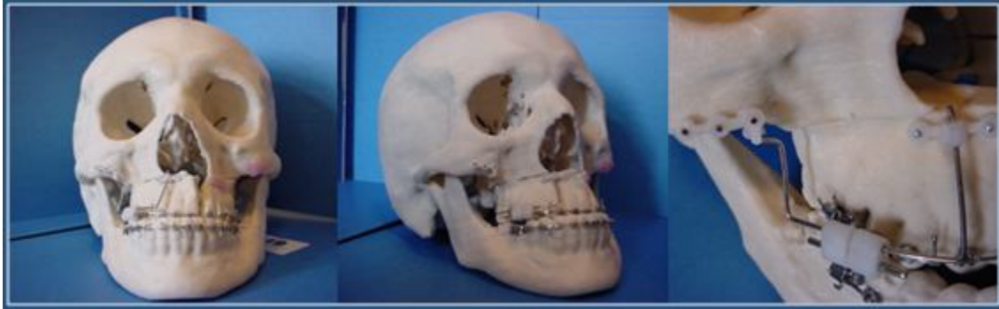
Figura 18.- Prototipo del distractor montado en la estereolitografía
