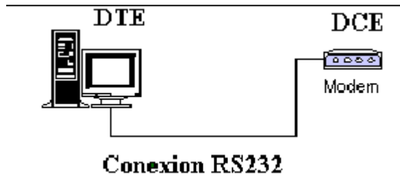
2.16.3.1 Figura Conexión RS232 entre PC y Modem
