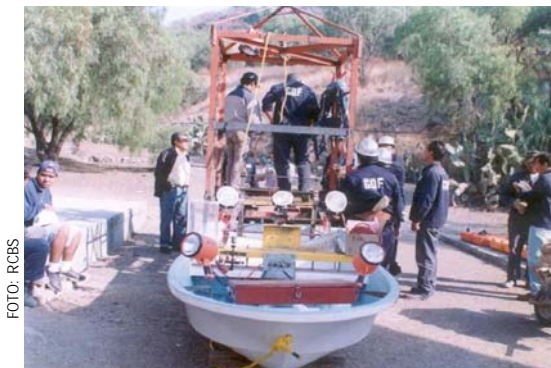
Fig. 1.26. Lancha equipada con videocámaras y un sistema de iluminación.
