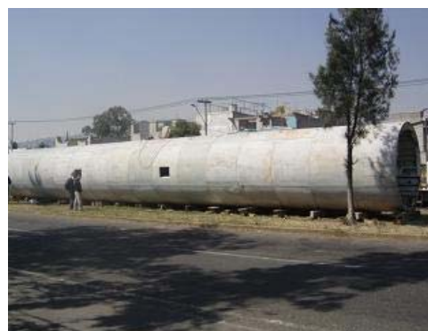
Fig. 1.15. Cimbra telescópica, vista exterior.
