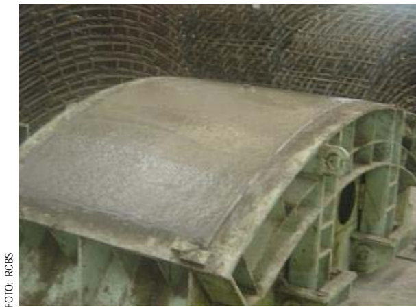
Fig. 1.8. Colado de las dovelas.
