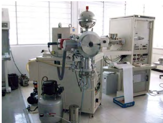
Figura 3.6. Espectrómetro de masas FINNIGAN MAT 262.
