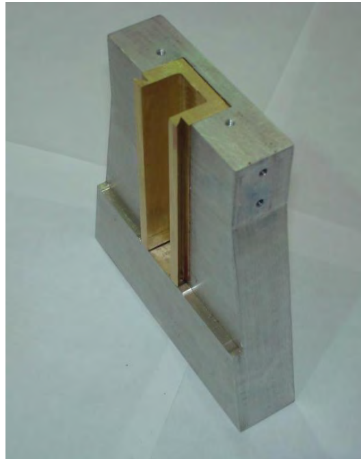
Figura 10. Guía ya maquinada y ensamblada
