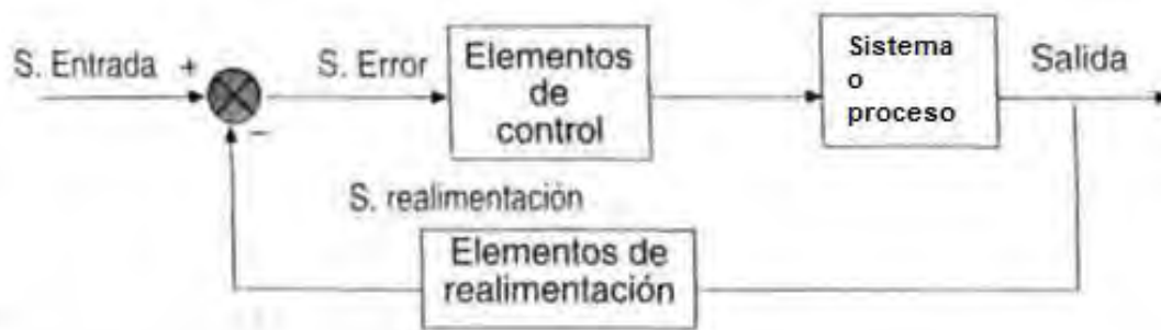
Figura 25. Sistema de control en Lazo cerrado.
