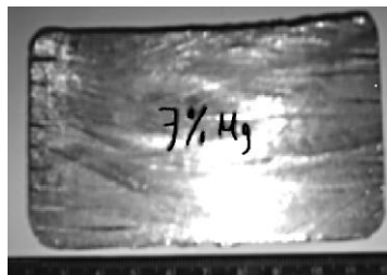
Figura 4.2 Lingote de la aleación 5.3%at Zn-7%at Mg maestra de donde se obtienen las cargas para los experimentos de solidificación unidireccional y atomización al vacío
