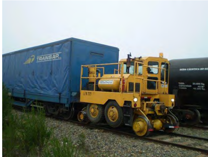
Figura 15. Tracmovil que mueve los vagones sobre la vía ferrea
