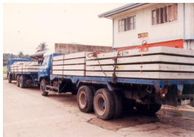
**Almacenamiento y transportación simple:** Con el ancho estándar de 8 ft (2.44 m) se almacenan y despachan muy bien en camiones de 8 ft (2.44 m), eliminando la necesidad de transportar los paneles en forma vertical como otros sistemas pre-moldeados.
