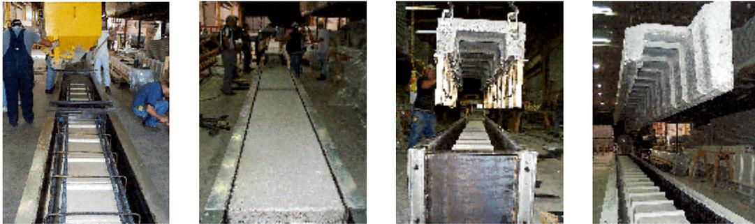
Los moldes están hechos de una aleación de plástico y aluminio y son muy fáciles de limpiar y preparar para el próximo llenado. Un molde ajustable se usa para moldear los elementos usados para las vigas y las columnas. El aislamiento térmico de los moldes le asegura un panel por día por molde sin el uso de aditivos o el uso de calor artificial o vapor. El marco de aluminio se afloja para poder permitir el sacado del panel del molde.
