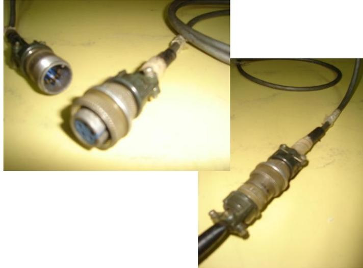
Fig. 2.7 Extremos compatibles de cables blindados
