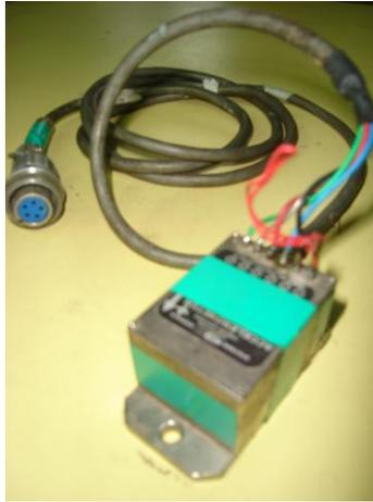
Fig. 2.4 Servo-acelerómetro
