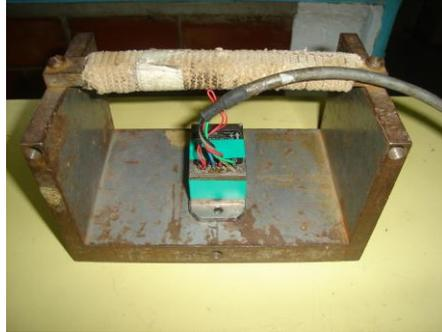
Fig. 2.20 Acelerómetro montado sobre base metálica
