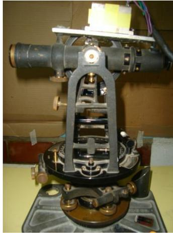
Fig. 2.14 Acelerómetro fijado al teodolito
