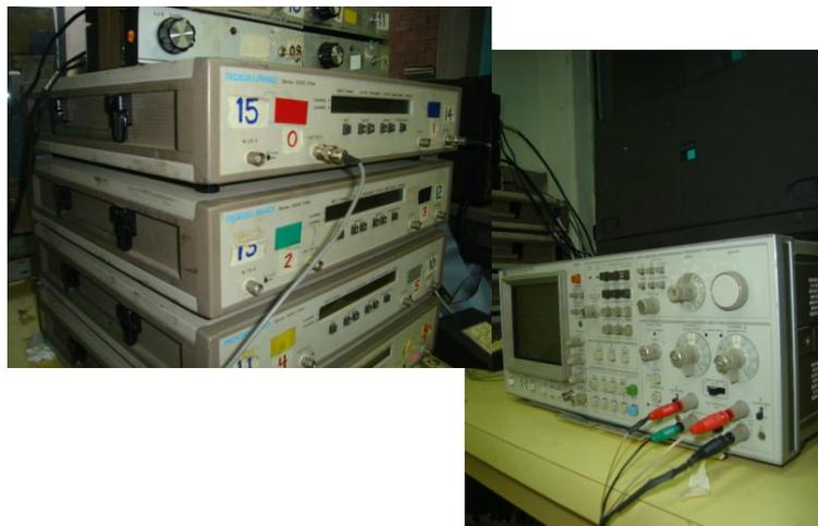
Fig. 2.12 Enlace filtro-analizador de espectros
