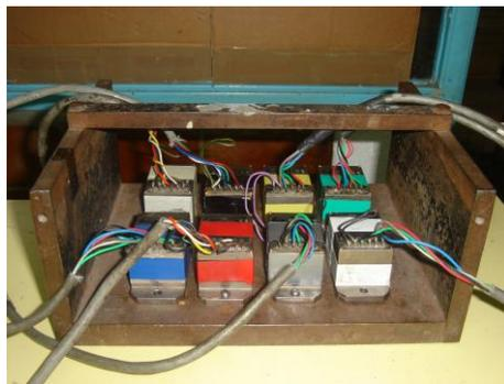
Fig. 2.17 Montaje de acelerómetros sobre base metálica
