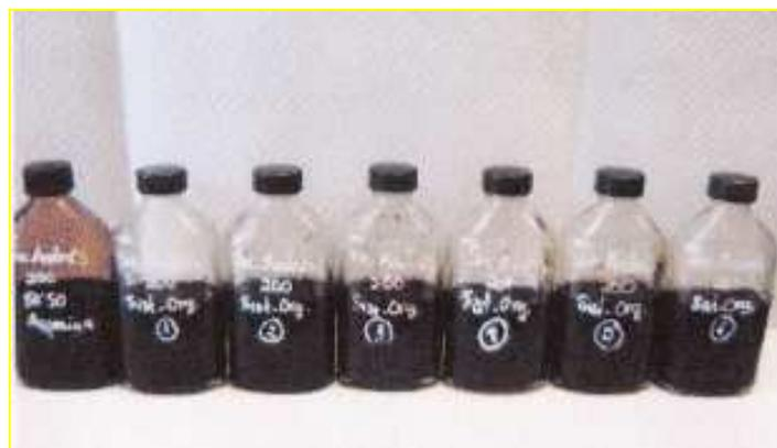
Después se hace una prueba de aceite con ácido con otra muestra de aceite del pozo para ver como reaccionara y saber si puede llegar a crear sludge que se convertiría en un problema.
