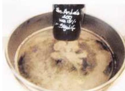
**Foto 2. El sistema no presenta Sludge, se observa que la malla queda manchada debido a la viscosidad del crudo.**
