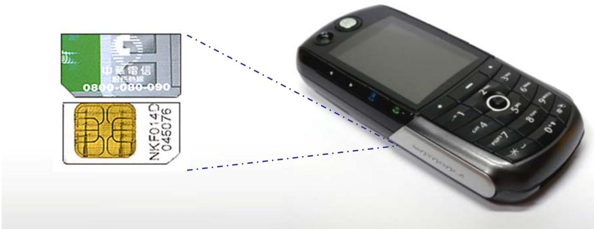
Tarjeta SIM o SIM card de un Equipo móvil
