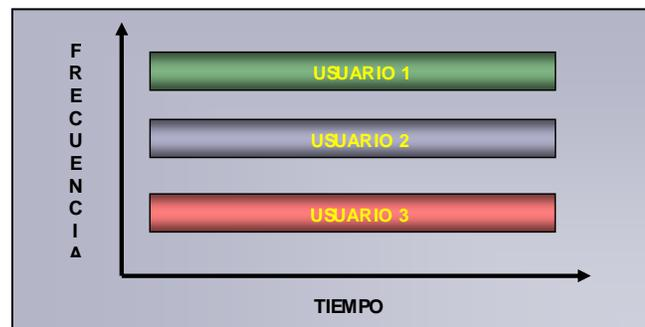
FDMA asigna un segmento o canal del espectro total a cada usuario. En la figura, cada banda representa una llamada con una transmisión continua sobre cada canal
