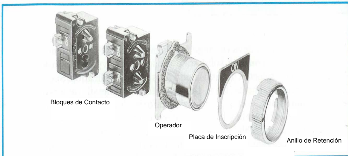
Figura 3.2 Unidad de botón pulsador y sus componentes.
