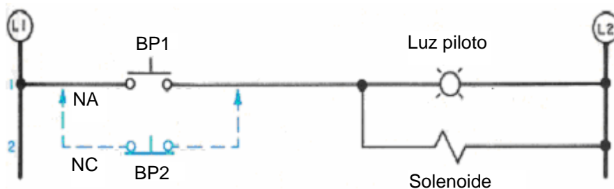
Figura 5.5 Circuito de control de la función NOT.
