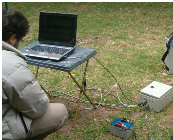
Figura 4.25. Instalación de la unidad sísmica SR04.
