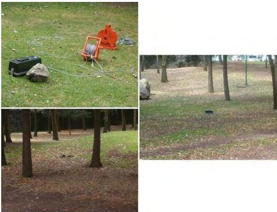
Figura 4.24. Instalación de los sensores sísmicos para la prueba en campo.
