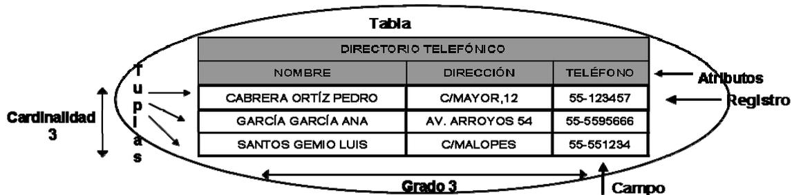
Figura 1.1. Ejemplo de elementos de una base de datos
