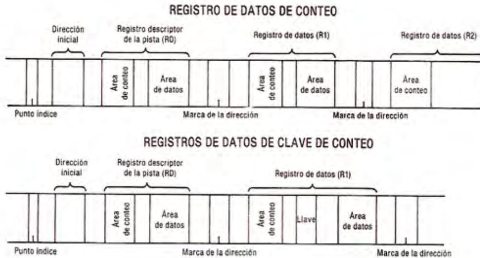
**Figura 1.7.** Almacenamiento de datos en un disco magnético.
