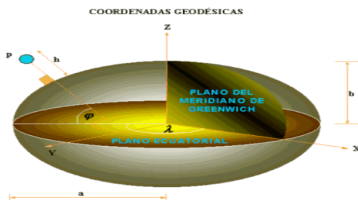
Figura 1.5 Elipsoide de Clark 1866 o GRS80 empleado en la Red Geodésica.
