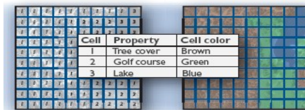
Figura 2.4 Representación de una imagen raster por medio de celdas. Fuente biblioteca ESRI Inc.
