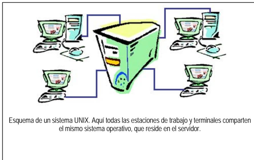
Ahora aclaremos la diferencia entre una terminal y una estación de trabajo. Las terminales están compuestas por un teclado y un monitor, nada más. No son capaces de ejecutar programas ni de almacenar información. Son, sencillamente, un dispositivo de entrada/salida por medio del cual el usuario se comunica con el servidor. Todas las operaciones y las tareas se realizan del lado del servidor.
