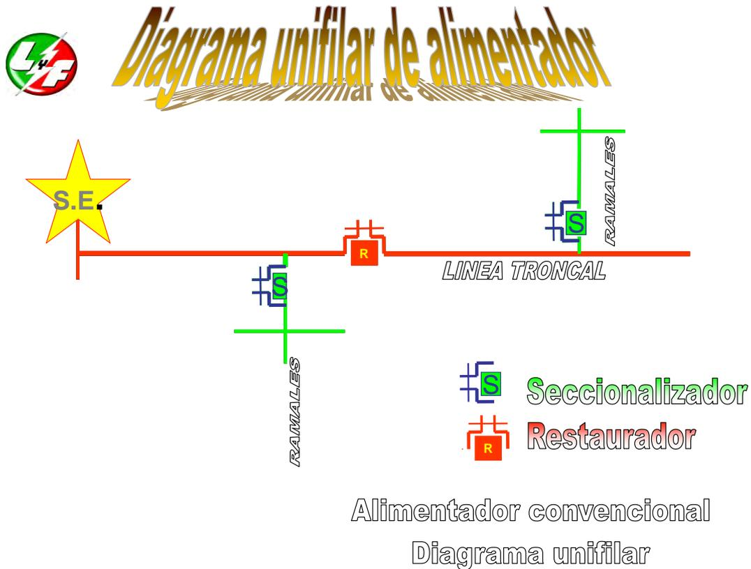
Fig. 20 Diagrama unifilar de un alimentador convencional con equipo de seccionamiento.
