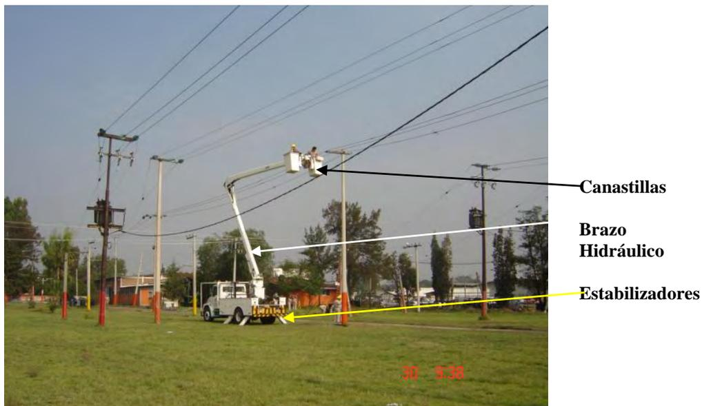
Fig. 19 Vehículo para maniobras con Línea Viva ó con potencial
