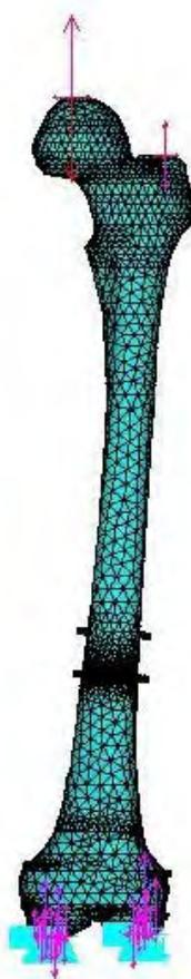
Figura 3.16 Condiciones de Frontera en el Fémur.
