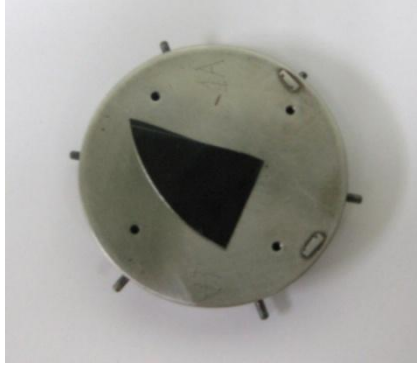
Fig. 3. Sustrato de Si (111) utilizado para el crecimiento de las películas de ZrO_2 , montado sobre un portasustratos de molibdeno.
