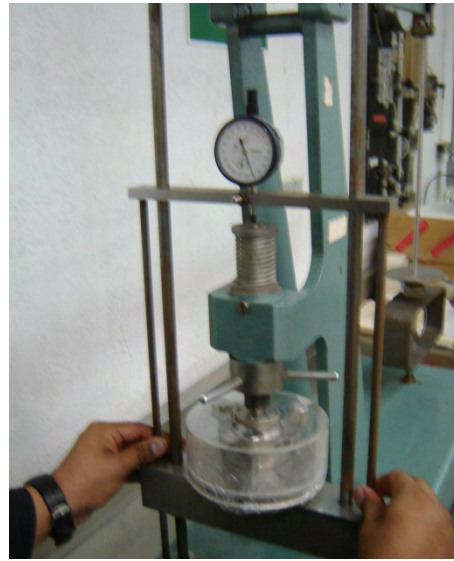
Fig. 5.15 Fijación de la cazuela de lucita en el puente de medida
