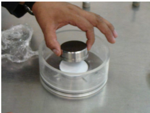
Fig. 5.12 Muestra de suelo en anillo colocada en la cazuela de lucita
