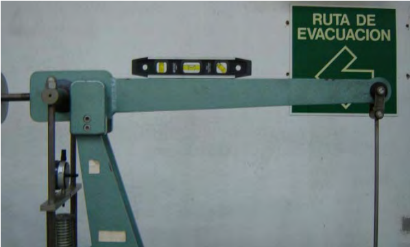
Fig. 5.14 Nivelación del marco de carga
