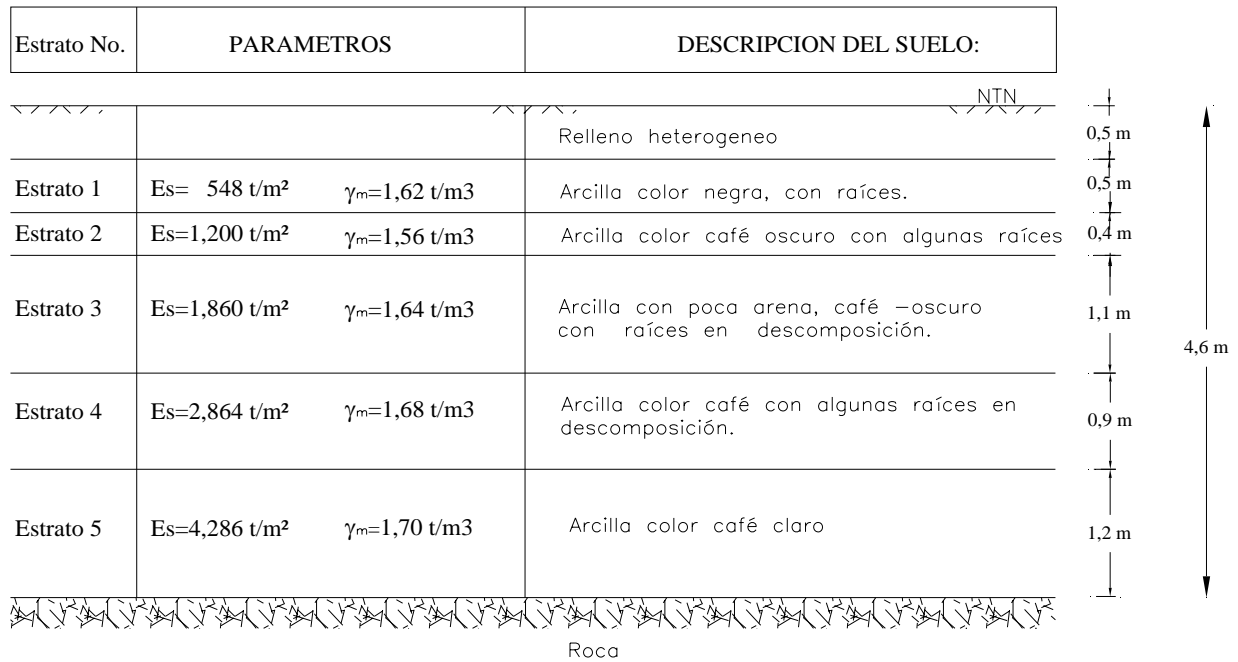
Fig. 5.22 Estratigrafía idealizada del suelo expansivo
