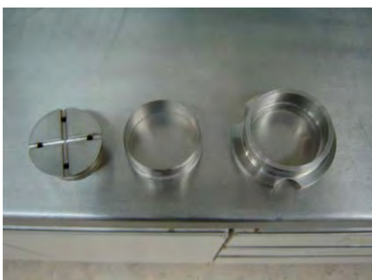
Fig. 5.10 Placa superior, anillo y porta anillo de la muestra en equipo Geonor
