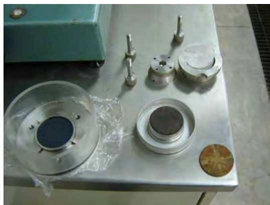
Fig. 5.11 Componentes de la cazuela de lucita
