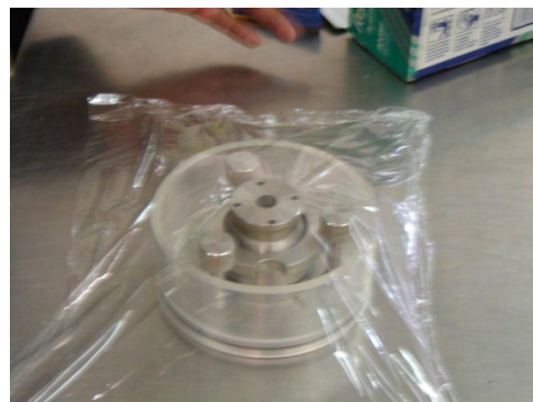
Fig. 5.13 Muestra cubierta con película de plástico
