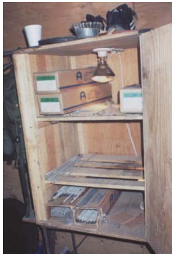
Fig. 2.3 Horno improvisado para el resecado de los electrodos
