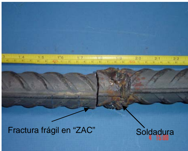
a) Fractura frágil en barra soldada N. 10
