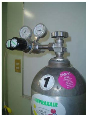
Figura VII.1. Tanque con gases contaminantes de ajuste.
