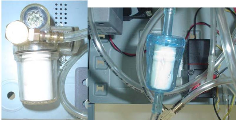
**Figura V.9. Filtro de partículas y Filtro adicional.**
