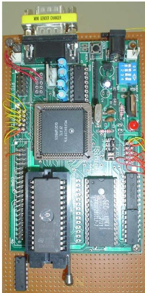
Figura V.12. Microcontrolador MC68HC11F1.
