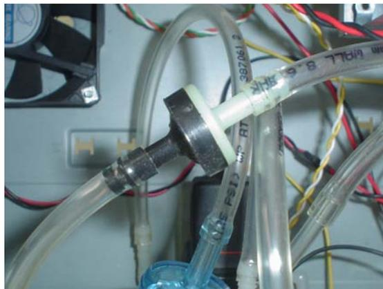
**Figura V.5. Válvula CHECK.**
