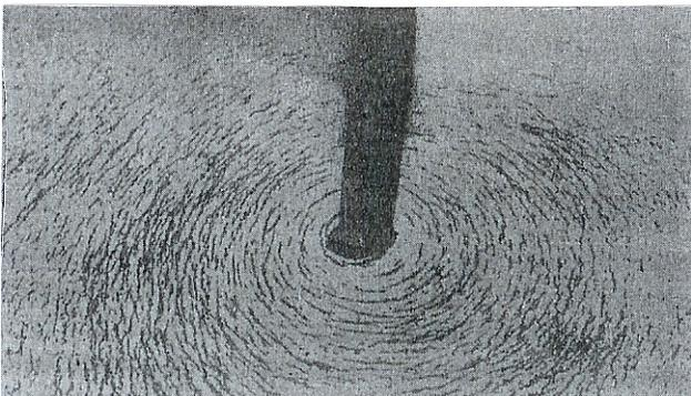
En la imagen se puede apreciar, por medio de las limaduras de hierro, el campo magnético que se produce alrededor del conductor cuando circula a través de él una corriente eléctrica.
