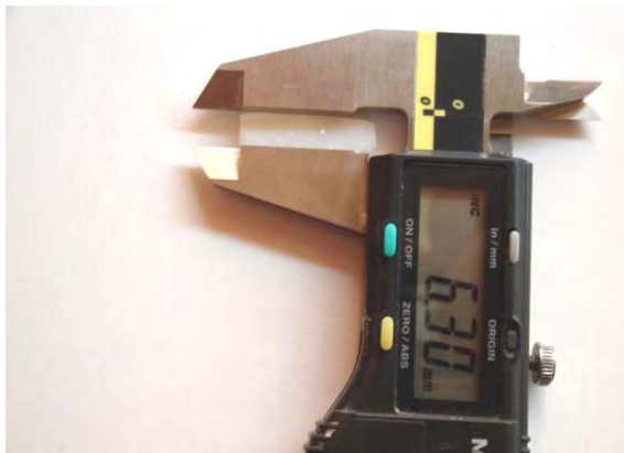
FIG.13 MEDICIÓN DE LAS MUESTRAS CON VERNIER DIGITAL
