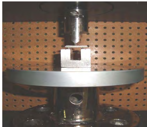
FIG.15 .1 MUESTRA DE CERÁMICA COLOCADA EN LA INSTRON.
