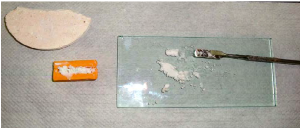
FIG. 9 INTRODUCCIÓN DE LA CERÁMICA AL MOLDE PREFABRICADO.
