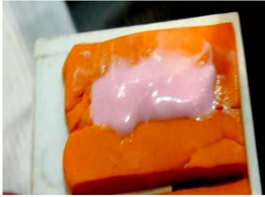
FIG. 10 Y 10.1 ELIMINACIÓN DEL EXCEDENTE DE LÍQUIDO Y COMPACTACIÓN DE LAS MUESTRAS
