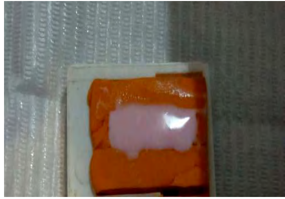
FIG. 10 Y 10.1 ELIMINACIÓN DEL EXCEDENTE DE LÍQUIDO Y COMPACTACIÓN DE LAS MUESTRAS
