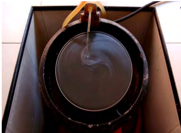
FIG. 6 PULIDORA ADECUADA CON LIJAS E IRRIGACIÓN
