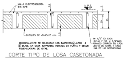
CORTE TIPO DE LOSA CASETONADA
