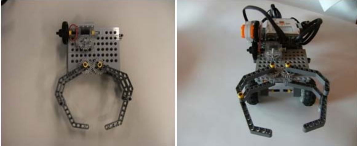
Figura 45. Gripper para la recolección de objetos
