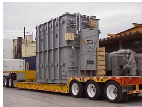
**Fig. No. 41 Embarque de transformadores**
