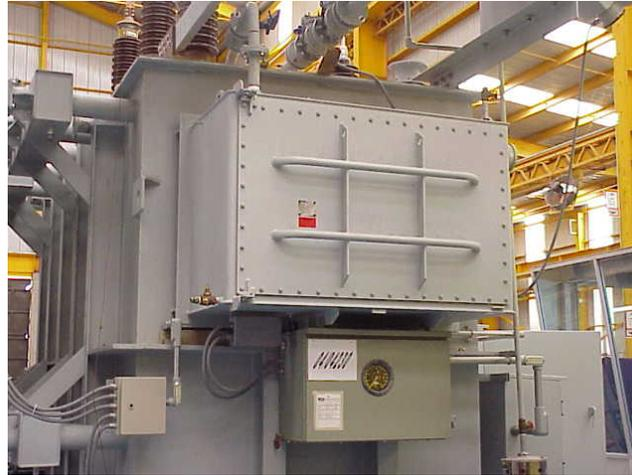
**Fig. No.19 Cambiador de derivaciones para operación bajo carga para B.T. tipo Inductivo (Reactivo).**
