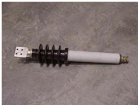
**Fig. No. 51 Ensamble de boquilla tipo sólido a tanque**
