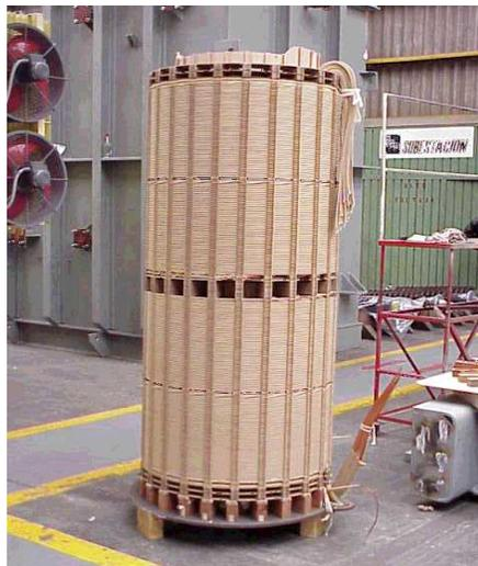
**Fig. No. 18. Bobina de baja tensión en forma cilíndrica.**
