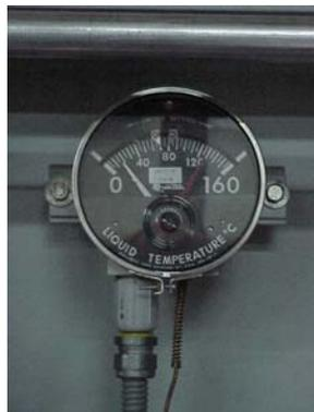
**Fig. No.25. Vista frontal de un indicador de temperatura con contactos de alarma.**
