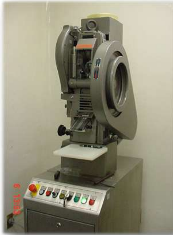
Figura 14. Tableteadora Monopunzónica Instrumentada Korsch EK-0/DMS
