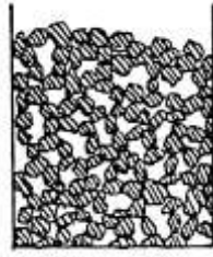
Figura 5. La cámara de compresión tras ser llenada se reacomodará por efecto de la fuerza aplicada [5]
