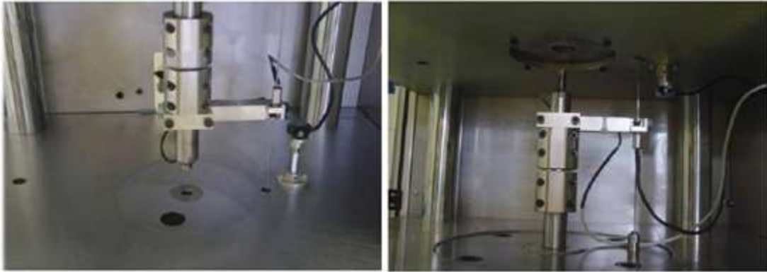
Figura 19. Punzón superior (izquierda) y punzón inferior (derecha) del simulador de compactación PCS-1 [19]
