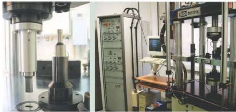
Figura 18. Simulador de compactación ESH, propiedad de FMC BioPolymer ubicado en Bruselas, Bélgica [25]
