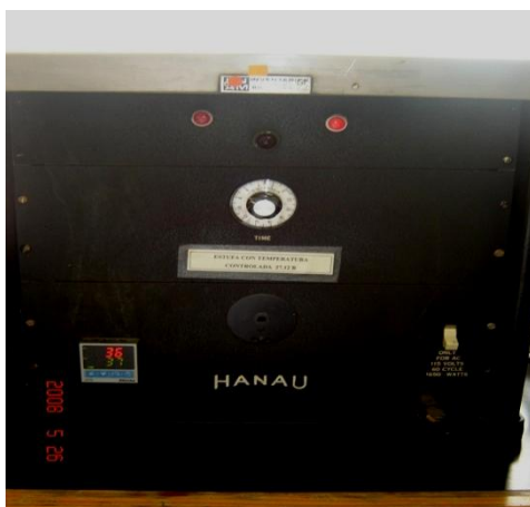
Fig. 11-12 Después de realizada la segunda mezcla se colocó en la estufa ( 37^{\circ}\pm 1^{\circ}\text{C} y 95% HR) durante 15 min.
