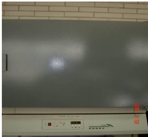
Fig. 15 Cabina con temperatura controlada (37°±1°C)
