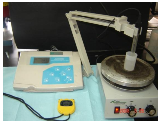
Fig.8 Se hizo la determinación de pH a los 5 y 10 min.
