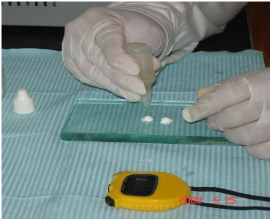
Fig.5 Posición vertical del gotero para dispensar el líquido
