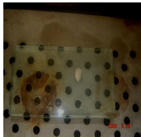
Fig. 11-12 Después de realizada la segunda mezcla se colocó en la estufa ( 37^{\circ}\pm 1^{\circ}\text{C} y 95% HR) durante 15 min.
