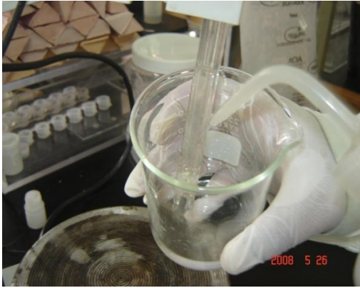
Fig.9 El electrodo se enjuagó y secó con papel absorbente entre cada medición
