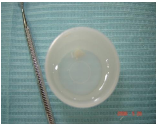
Fig.7 La muestra fue colocada en un recipiente de polipropileno con 20 mL de agua desionizada.
