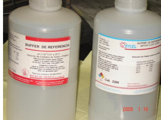
Fig.10 soluciones buffer utilizadas para la calibración
