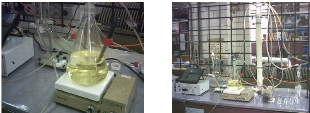
Figura 3.5. Arreglo experimental del sistema de oxidación con O_3 y O_3-H_2O_2
